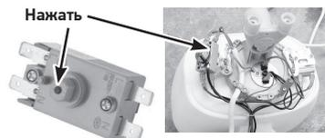
Рисунок 3. Расположение штока термовыключателя на термостате.
